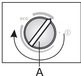
In caso di temperatura ambiente inferiore ai 16 °C si consiglia di impostare la manopola **A** sulla parte **più sottile dell'indicazione**.
